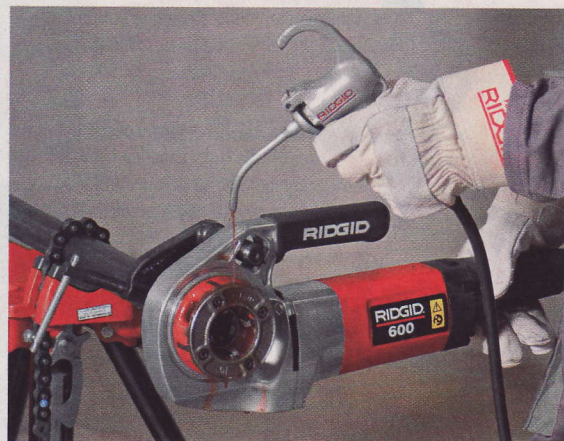
Rezačka závitov 600-C sa dodáva v kufríku spolu opierkou a reznými hlavicami na rúrky s rozmermi 1/2", 3/4", 1", a 1 1/4".
