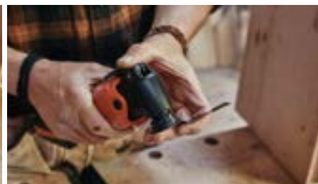
... jednoducho vložte príslušenstvo do úchytky Starlock a zacvaknite na miesto. Hotovo!
