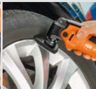
Špeciálne papiere s veľmi jemnou zrnitosťou sú ideálne na odstraňovanie nedostatkov a defektov laku.
