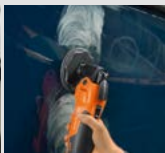
Škrabance v laku vozidla odstránite pletenou leštiacou podložkou a leštiacim prostriedkom.
