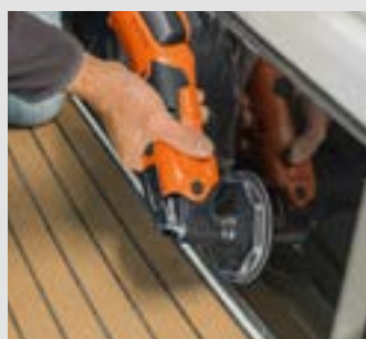
Brúsne listy s molitanovou penou na odstránenie škrabancov napríklad na akryle a polykarbonáte.
