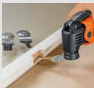
Tvrdokovová rašpľa na čistenie a brúsenie drážok, otvorov a záhybov.
