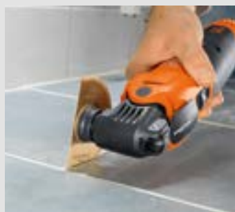
Pilové kotúče s hrúbkou 1,2 mm dokážu vyrezať aj veľmi úzke škáry.
