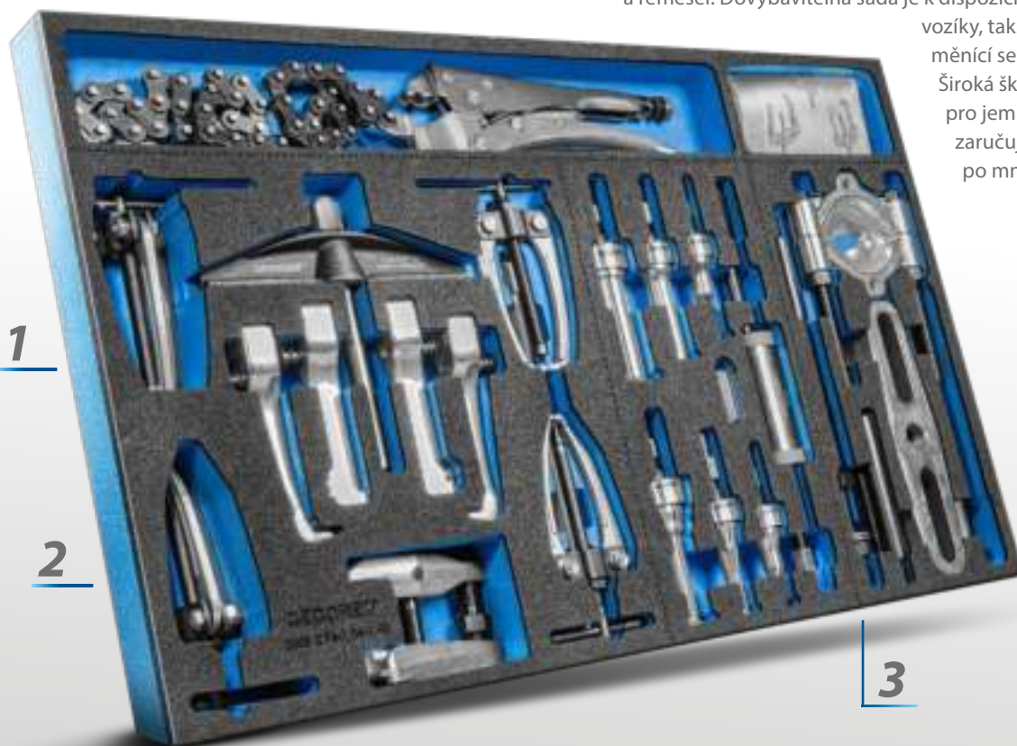
Sada stahováků vnějších a vnitřních separátorů pro dílenské vozíky a lavice - 2005 CT4-1.04-1.40
